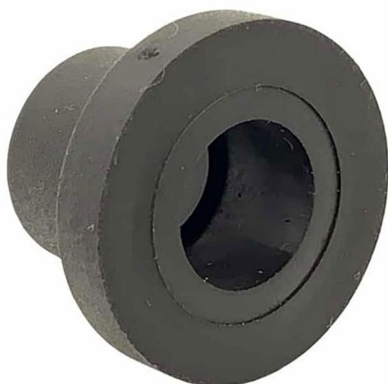
La arandela de goma aislante de 6mm provee una conexión estanca de la manguera de 6mm con el tanque rígido de 47L de AutoPot. Se inserta en el orificio en la parte inferior del tanque (que puedes taladrar también en tu propio depósito para el agua). Inserta entonces la arandela en el orificio y a su vez el tramo de 6mm de manguera por la arandela, de forma que su extremo salga hacia el interior del tanque.
